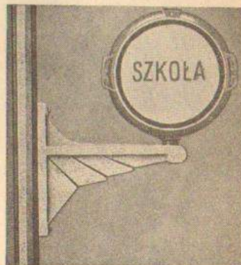
Rys. 20. Tablica ostrzegawcza na wysięgniku żelbetowym; długość 0,40 do 1,20 m
