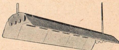
Rys. 23. Otwarta oprawa przemysłowa do czterech świetlówek, kierująca przeważną część strumienia świetlnego do dołu oraz niewielką część (około 1/3) ku górze przez szczeliny widoczne w górnej części odbłyśnika. Oprawa taka nosi nazwę oprawy do oświetlenia przeważnie bezpośredniego
