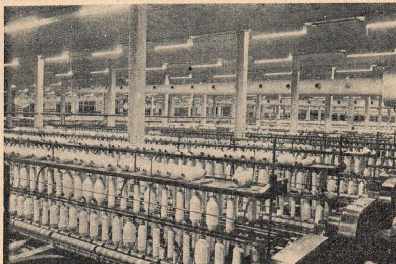
Rys. 34. Duża hala przędzalni oświetlona przy użyciu opraw do oświetlenia bezpośredniego, rozmieszczonych równomiernie nad całym polem pracy. Jasne ściany, sufit, słupy oraz urządzenia produkcyjne zmniejszają kontrasty jaskrawości
